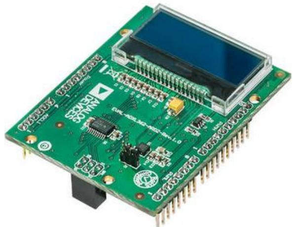
► CN0338 NDIR Gas Sensing shield
